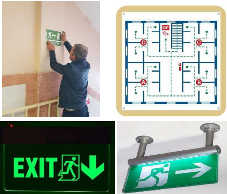
شکل ۶: نقشه مسیره‌های خروج اضطراری از یک طبقه ساختمان و علائم راهنمای مربوطه
