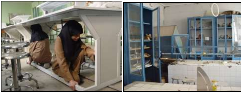
شکل ۱۲: نمونه‌ای از سقوط کمد‌های حاوی مواد شیمیایی هنگام وقوع زلزله و نحوه پناه‌گیری در آزمایشگاه
