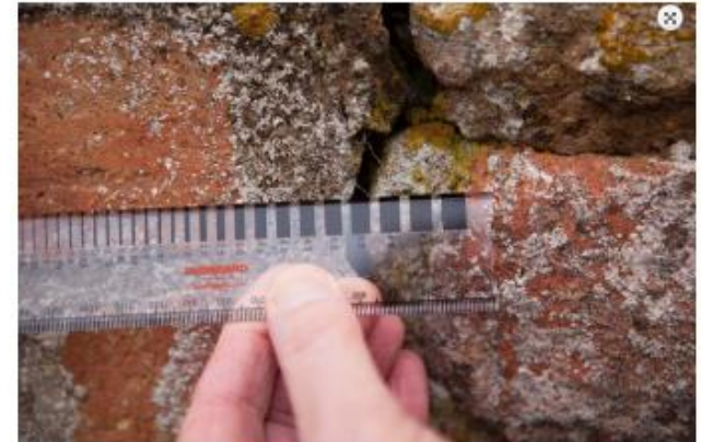
شکل (۴-۲): خط کش مدرج شفاف برای تعیین عرض ترک
