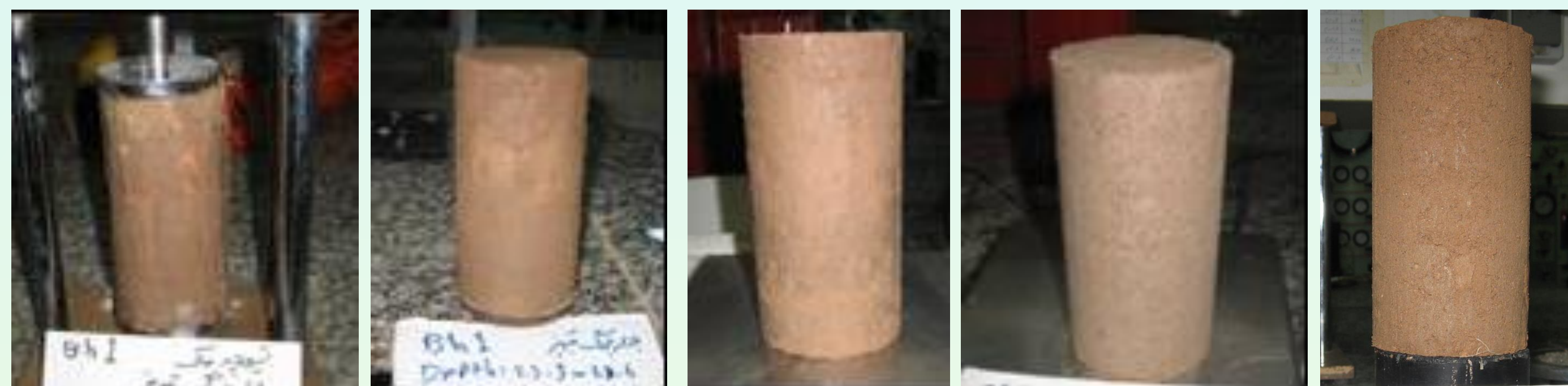
تصاویر تعدادی از نمونه های ساختمانی تیمچه ملک بازار تبریز قبل از آزمایش
