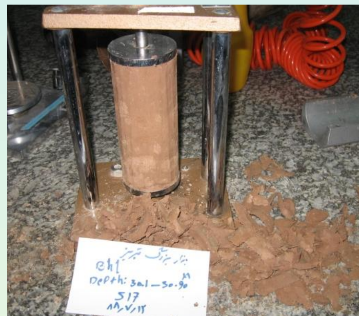
تصویر ساخت نمونه دست نخورده به روش کاهش قطر در قالب تنظیم قطر نمونه
