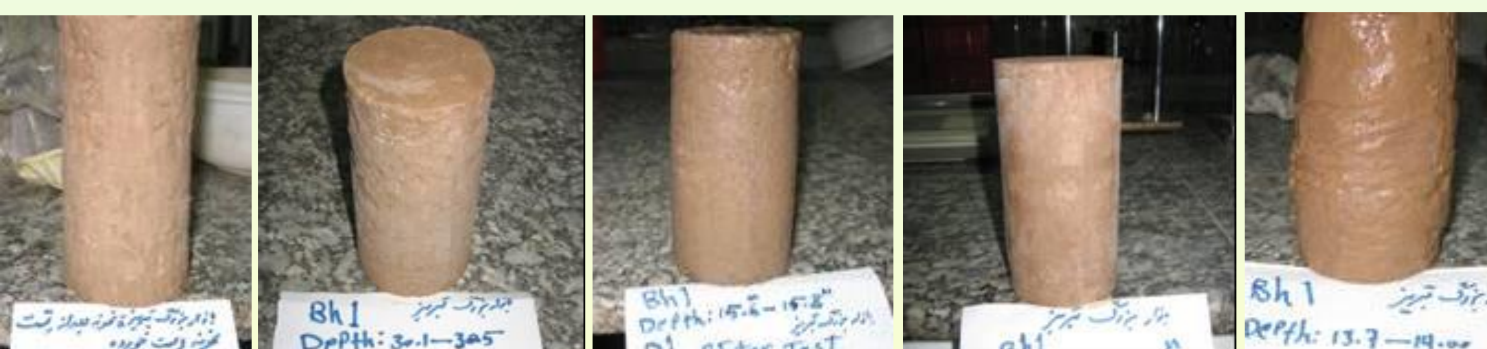
تصاویر تعدادی از نمونه های ساختمانی تیمچه ملک بازار تبریز پس از آزمایش
