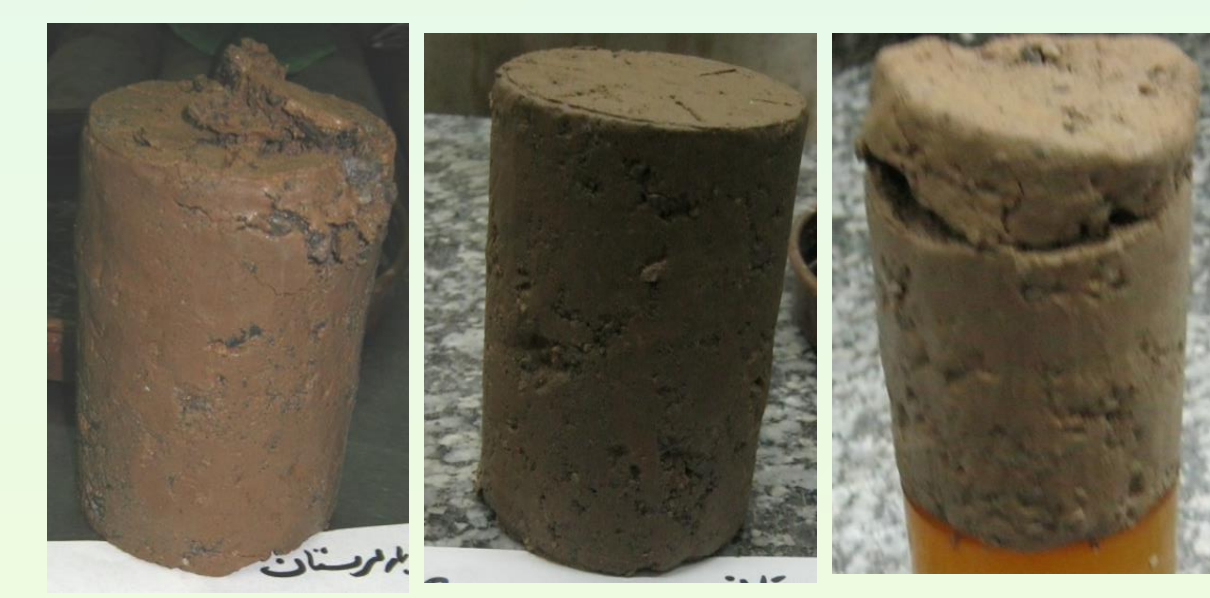
تصویر تعدادی از نمونه های هسته سد در آزمایش ستون تشدید پس از آزمایش
