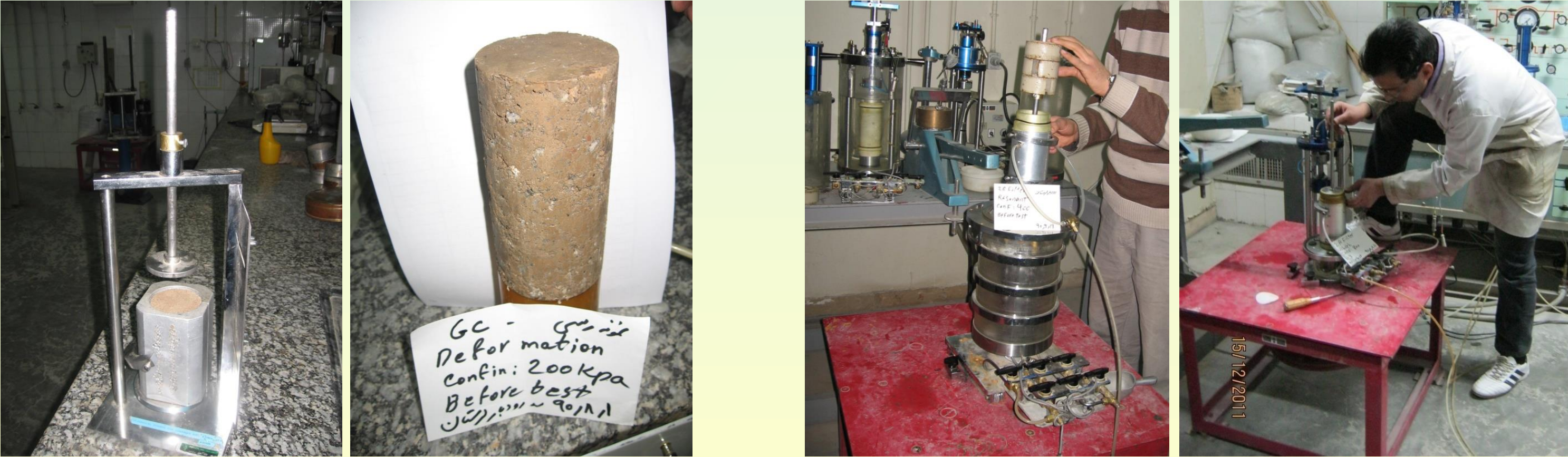
نحوه ساخت نمونه با چکش تراکم
