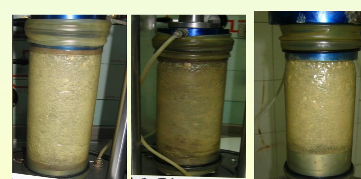
تصویر تعدادی از نمونه های فیلتر سد در آزمایش سه محوری تناوبی مقاومتی قبل از آزمایش
