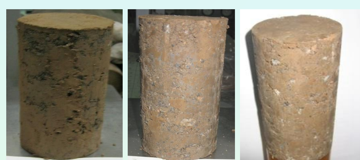
تصویر تعدادی از نمونه های هسته سد در آزمایش سه محوری تناوبی تغییر شکلی قبل از آزمایش
