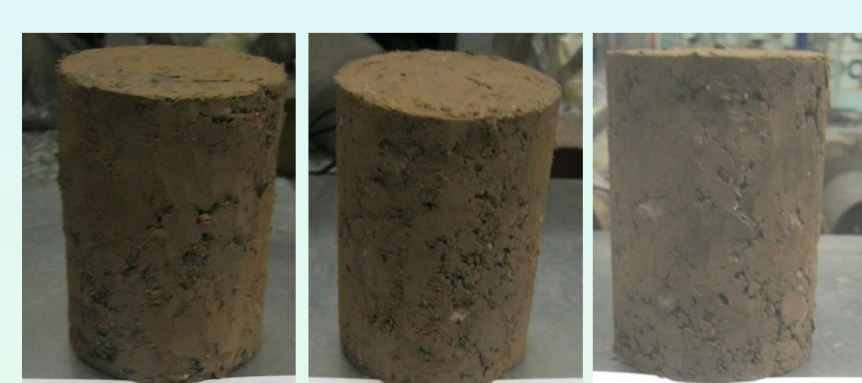
تصویر تعدادی از نمونه های هسته سد در آزمایش ستون تشدید قبل از آزمایش
