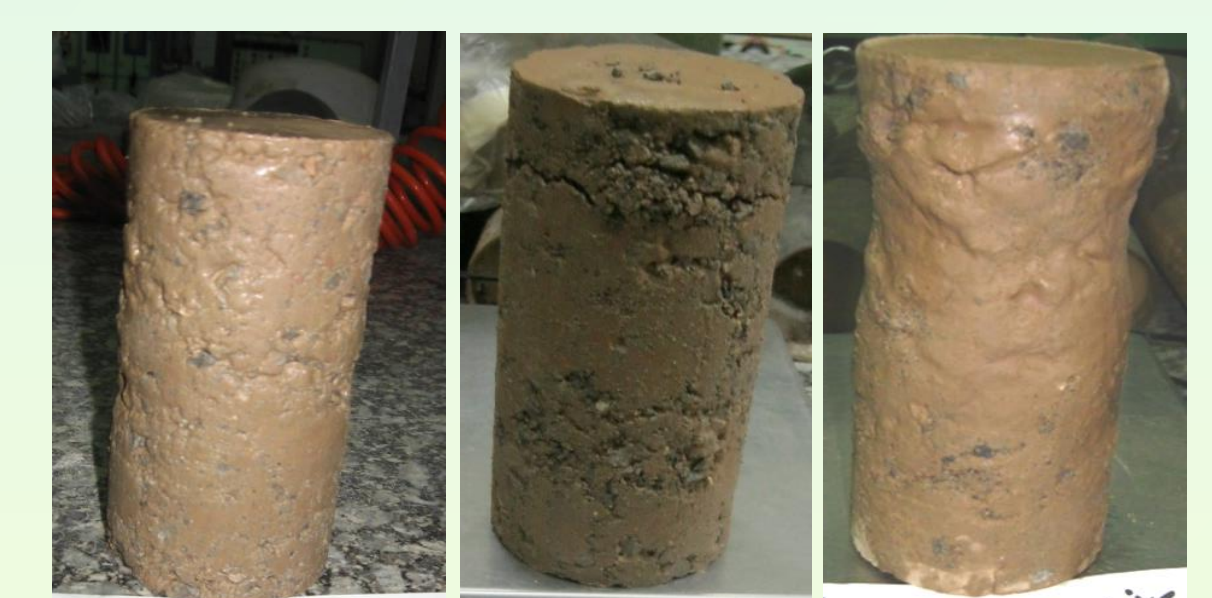
تصویر تعدادی از نمونه های هسته سد در آزمایش سه محوری تناوبی تغییر شکلی پس از آزمایش
