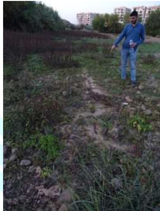
شکل ۲-۸- تصاویری از پدیده روانگرایی و جوشش ماسه در نقاط مختلف بستر رودخانه در مجاورت مجتمع مسکن مهر شهید شیرودی
