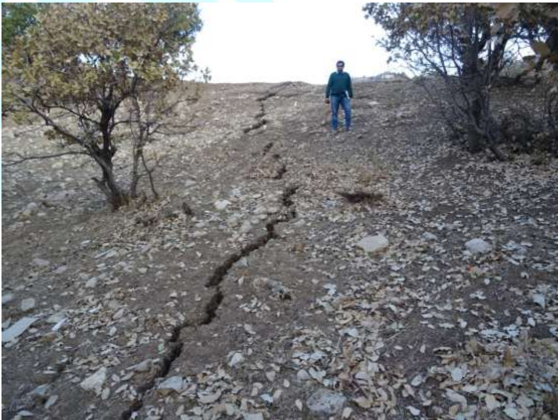
شکل ۳-۱۳ - نمونه‌هایی از شکاف‌های طولی در بخش پایینی پهنه لغزشی شمال دالاهو در امتداد شیب دامنه
