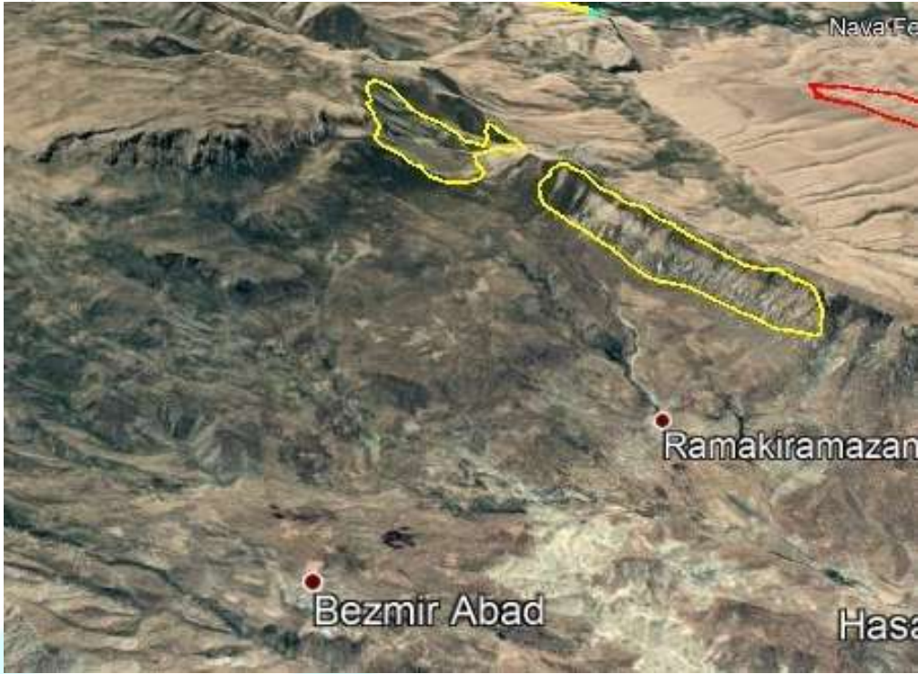
شکل ۳-۳۳- محدوده ریزش‌های سنگی در یال شمالی ناودیس معلق ریجاب
