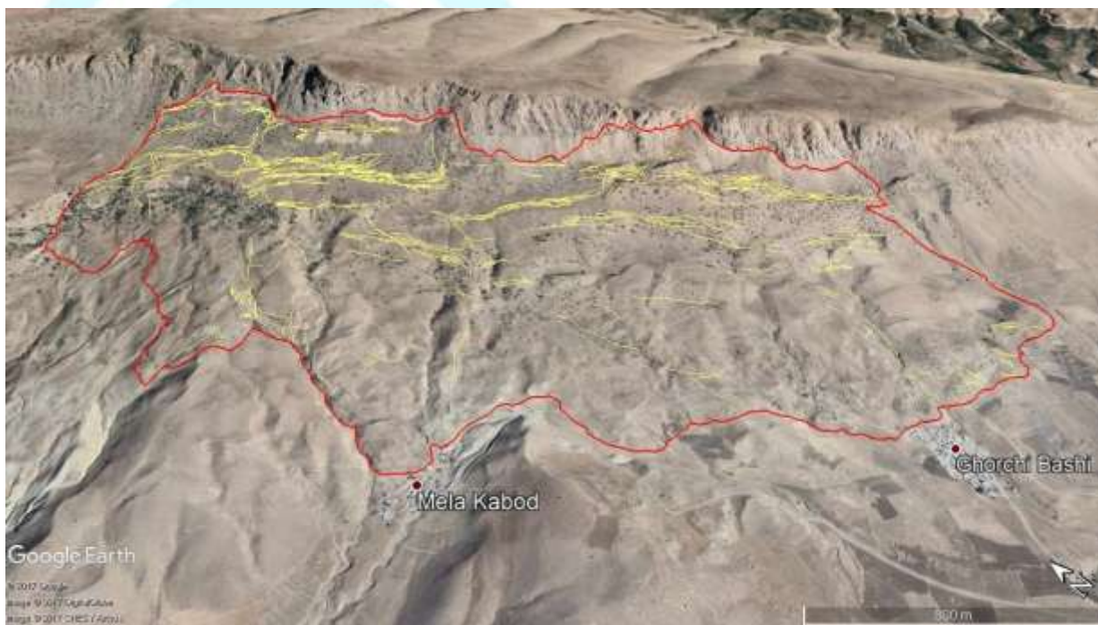
شکل ۳-۴- تصویر ماهواره‌ای زمین لغزش مله کبود-قورچی باشی همراه با شکاف‌های عرضی و طولی پیداده شده بر روی آن (خطوط زرد)
