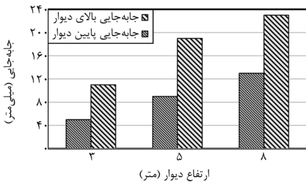
شکل (۴): تأثیر هندسه‌ی دیوار بر جابه‌جایی لرزه‌ای دیوار.
