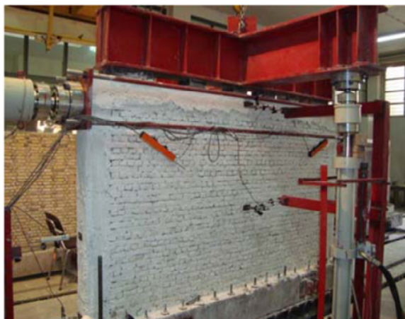
شکل (۸): نمایی از دو نمونه دیوار آجری کلافدار مورد آزمایش [۹].
