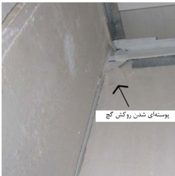
شکل (۱۴): ترک‌های کنج در گوشه‌های فوقانی و تحتانی دیوار تحت نیروهای درون‌صفحه‌ای در مرحله‌ی شتاب 0.7g .
