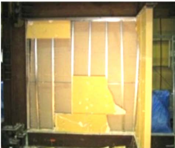
شکل (۱۲): نحوه توزیع خسارات در دیوارهای متعامد [۱۰].
