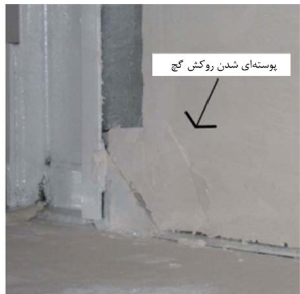
شکل (۱۴): ترک‌های کنج در گوشه‌های فوقانی و تحتانی دیوار تحت نیروهای درون‌صفحه‌ای در مرحله‌ی شتاب 0.7g .
