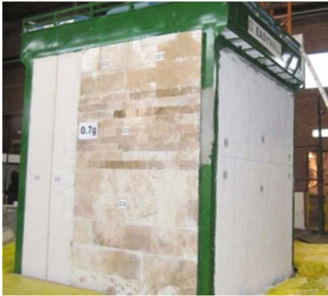
شکل (۱۳): نمونه‌ی مورد آزمایش برای پانل‌های کامپوزیت معدنی فوق سبک تحت نیروهای درون و برون‌صفحه‌ای به دو صورت با و بدون بازشو و با انواع نما و زیرسازی.
