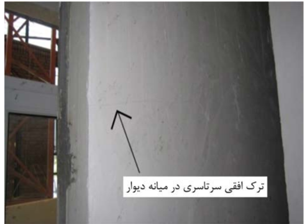
شکل (۱۵): ترک افقی سرتاسری در میانه‌ی تیغه تحت نیروهای برون‌صفحه‌ای در مرحله‌ی شتاب 0.7g .
