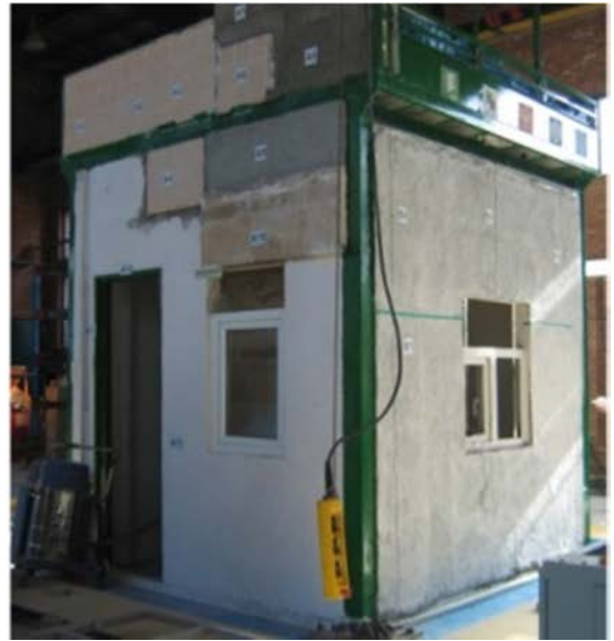
شکل (۱۳): نمونه‌ی مورد آزمایش برای پانل‌های کامپوزیت معدنی فوق سبک تحت نیروهای درون و برون‌صفحه‌ای به دو صورت با و بدون بازشو و با انواع نما و زیرسازی.
