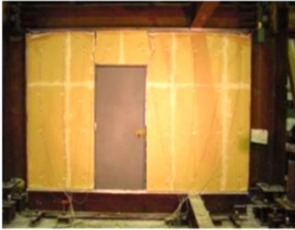
شکل (۱۱): نحوه‌ی توزیع خسارات در دیوار با بازو [۱۰].
