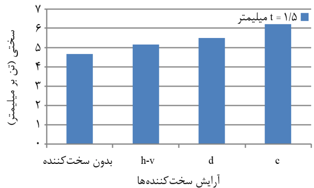
نمودار (۲۱): مقایسه نمودارهای سختی الاستیک حاصل از آنالیز برای دیوار برشی فولادی با بازشو ۲۵ درصدی به ضخامت ۱/۵ میلیمتر با آرایشهای مختلف سخت‌کننده‌های یکطرفه.
