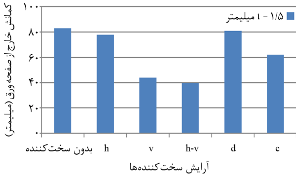
نمودار (۱۹): مقایسه نمودارهای کمانش خارج از صفحه با انواع آرایش سخت کننده‌های یکطرفه.
