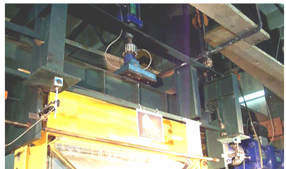
شکل (۲): نحوه بارگذاری مدل در آزمایشگاه بر روی دیوار برشی فولادی به ضخامت ۱/۵ میلی‌متر [۲].
