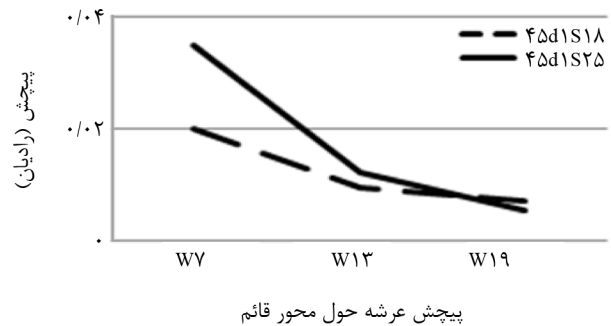
شکل (۸): روند تغییرات جابه‌جایی طولی، عرضی و پیچش عرشه پلهای تک‌دهانه نسبت به تغییر عرض دهانه.
