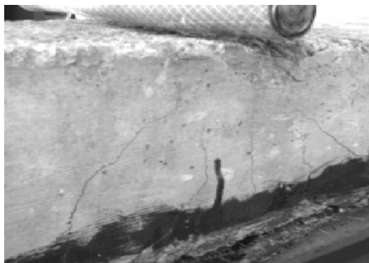
شکل (۹): شکست فشاری با ترک مورب و جداسدگی الیاف.
