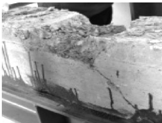
شکل (۸): شکست فشاری با ترک مورب در تیر با تقویت.
