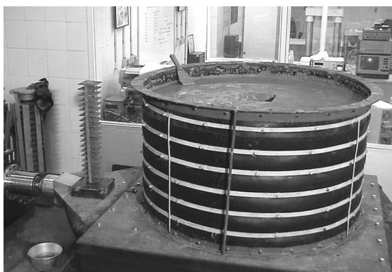
تصویر (۳): نمایی از آزمایشهای میدان آزاد و سازه با پایه گیردار.
