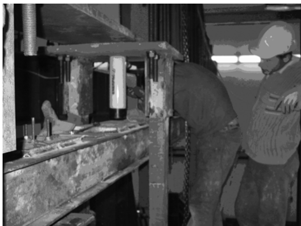
شکل ۴. تیر 2IPE18، جک استاتیکی و مهار جانبی.
