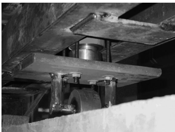
شکل ۵. غلتک متصل به نیروسنج جهت اعمال بار قائم به شناژ فوقانی نمونه‌های آزمایشگاهی.
