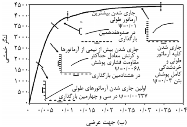
شکل (۷): تحلیل لنگر-انحنای المان پایه.
