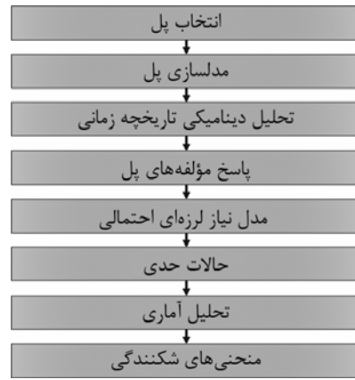
شکل (۸): روند محاسبات منحنی شکنندگی.
