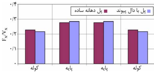
شکل (۵): نسبت عکس‌العمل طولی به برش پایه در راستای طولی در پل سه‌دهانه با دهانه‌های برابر.
