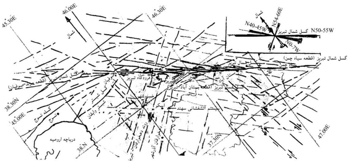
شکل (۲): نقشه تفصیلی روند شکستگی های بنیادی و خطواره های پیرامون تبریز، تهیه شده بر اساس تصاویرهای هوایی، ماهواره ای و بازدیدهای صحرایی
