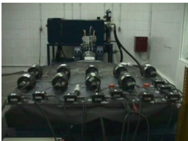
شکل (۲): آزمایش کالیبره کردن حس گرهای FBA-11 و SS-1 بر روی میز لرزان پژوهشگاه
