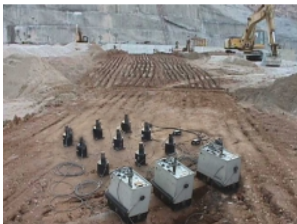
شکل (۱): آزمایش کالیبره نمودن حس گرهای سرعت سنج SS-1 و شتاب نگار FBA-11 در مرکز تاج سد مسجدسلیمان. کلیه حس گرها، ارتعاشات محیطی مرکز تاج سد را به صورت همزمان در جهت قائم ثبت می کنند.
