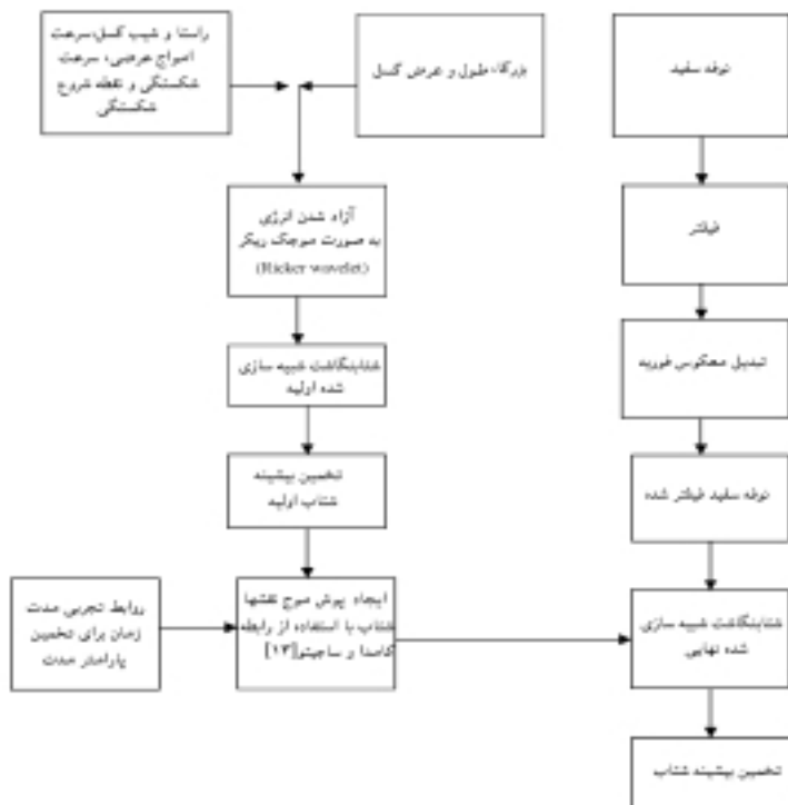
شکل (۳): الگوریتم روش شبیه سازی جنبش نیرومند زمین با استفاده از روش موجک، پروس موج نقشها و نوفه سفید
