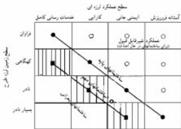
شکل (۱): اهداف عملکرد توصیه شده برای طرح لرزه‌ای ساختمانها [۶] ۵-۲- اطلاعات مورد نیاز در طراحی بر پایه عملکرد
