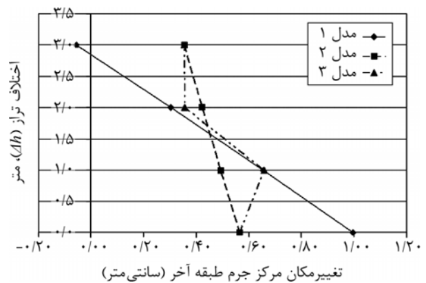
شکل (۲۵): بررسی تغییرات (تغییرمکان- اختلاف تراز) در بلوک B در جهت X (Combo4).
