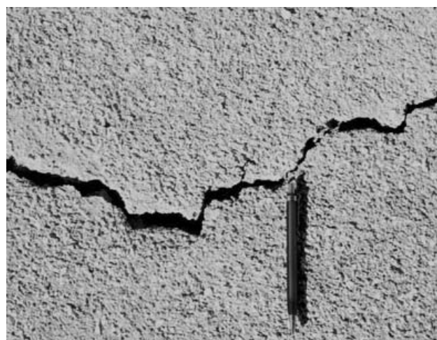
تصویر (۲، الف و ب): در پهنه گسیختگی جنوب باختر روستای جی جیان، شکستگی‌های راست‌الغز راست‌بر با روند ۲۳۰-۲۴۰ درجه در موقعیت ۲۶° ۵۰/۸۳' شمالی و ۵۶° ۰۰/۵۳۷' خاوری (نگاه به شمال باختر)
