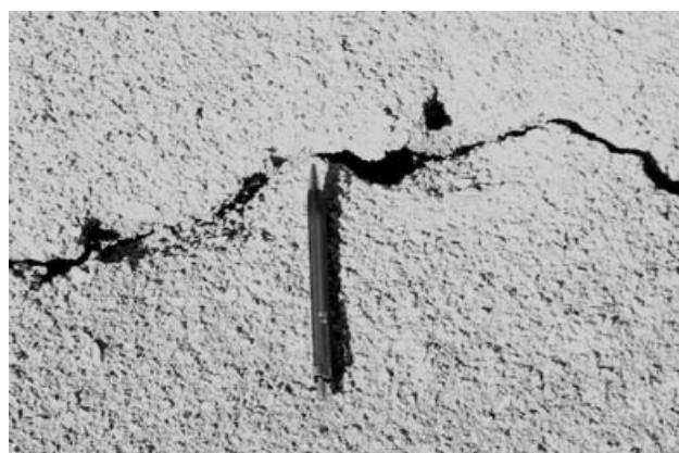
تصویر (۳، الف): شکستگی‌هایی با یک آرایش نردبانی و روند ۲۲۵ تا ۲۴۵ درجه که شیب کمی به سمت شمال باختر یا جنوب خاور دارند، سبب رانده شدن قطعاتی از خاکهای سطحی بر روی یکدیگر شده‌اند (نگاه به شمال باختر).
