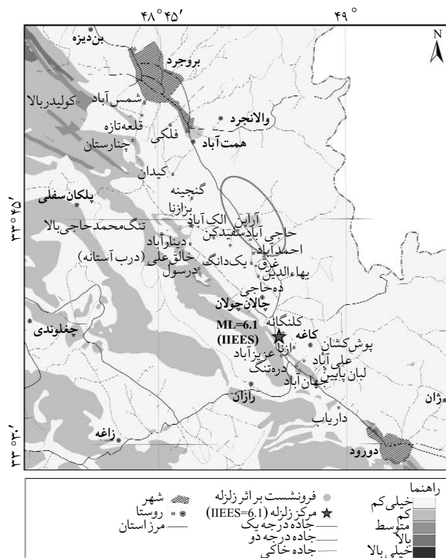
شکل (۱۰): نقشه پهنه بندی خطر فرونشست زمین [۶] به همراه محل فروچاله‌های حاصل از تخریب سقف قنات‌های منطقه
