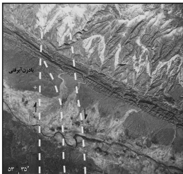
تصویر (۴): عکس هوایی دامنه جنوبی تاقدیس لوارستان. بادزن آبرفتی منتهایلیه غربی عکس از ارتفاع بیشتر و شیارهای عمیق تری نسبت به بادزنهاى دیگر برخوردار است. به نظر می رسد که این فرایش در نتیجه فعالیت گسل رازک روی داده است.
