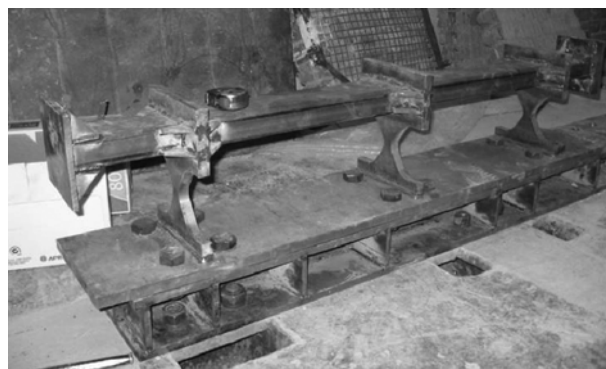
شکل ۵. تصویر یک نمونه آزمایشگاهی برشگیر فولادی.
